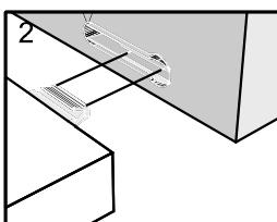
Zum Anschließen den Stecker in das Gehäuse schieben
