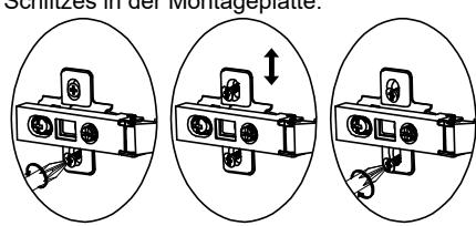
C. Einstellung von vorne nach hinten durch Drehen der Schraube im oder gegen den Uhrzeigersinn
