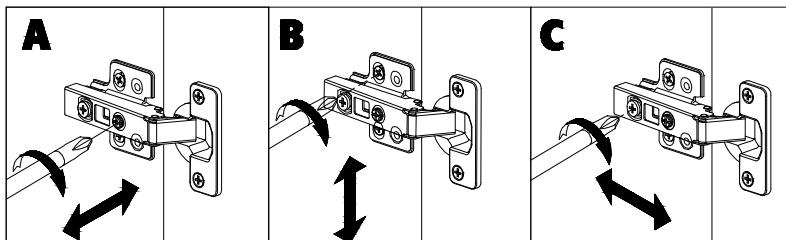
**A. Einstellung Seite an Seite durch Verstellung im oder gegen den Uhrzeigersinn.**
