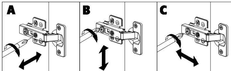
**A.** Einstellung Seite an Seite durch Verstellung im oder gegen den Uhrzeigersinn.
