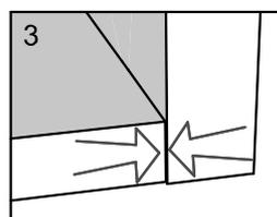
Zum Anschließen den Stecker in das Gehäuse schieben
