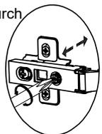
B. Einstellung nach oben und unten durch Verstellen des Schlitzes in der Montageplatte.
