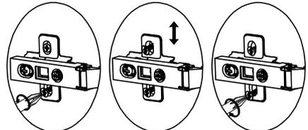
C. Einstellung von vorne nach hinten durch Drehen der Schraube im oder gegen den Uhrzeigersinn
