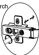
B. Einstellung nach oben und unten durch Verstellen des Schlitzes in der Montageplatte.
