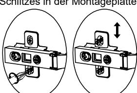
C. Einstellung von vorne nach hinten durch Drehen der Schraube im oder gegen den Uhrzeigersinn
