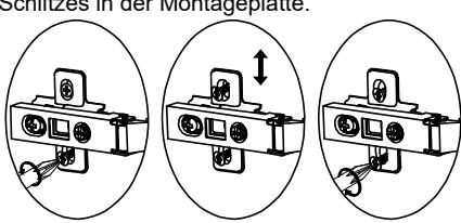
C. Einstellung von vorne nach hinten durch Drehen der Schraube im oder gegen den Uhrzeigersinn
