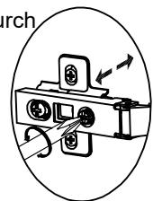
B. Einstellung nach oben und unten durch Verstellen des Schlitzes in der Montageplatte.
