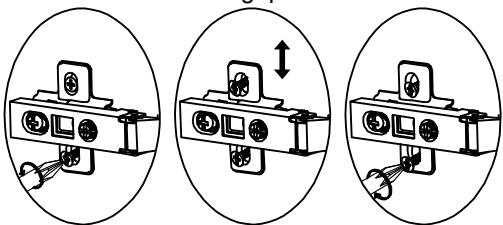
C. Einstellung von vorne nach hinten durch Drehen der Schraube im oder gegen den Uhrzeigersinn
